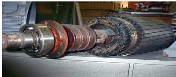
**Fig I. 8 :** Machine asynchrone à rotor bobiné
