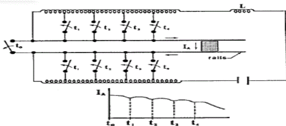
Figure II.8 Décharge de multiple courant
