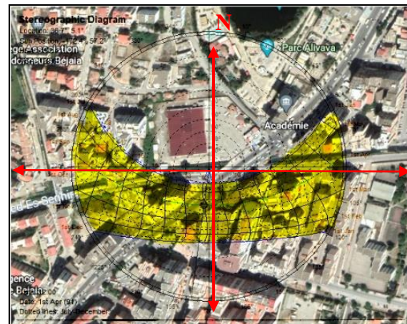
Figure 88: ensoleillement du terrain Source : Ecotect
