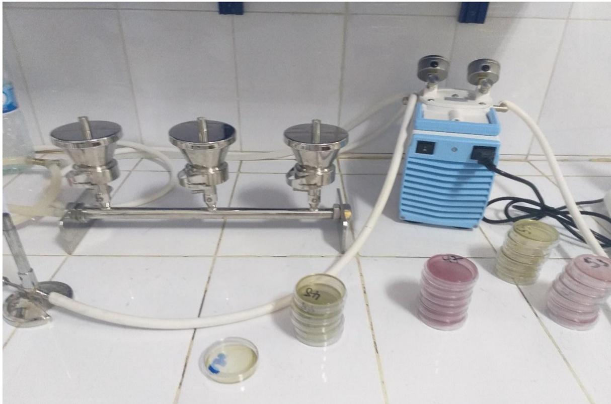
**Figure II.9 : Appareil utilisé pour le système de filtration.**
