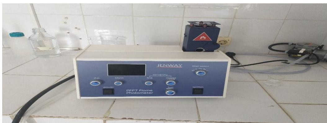
**Figure II.8: Spectrophotomètre d'émission de flamme****a. Réactifs**
