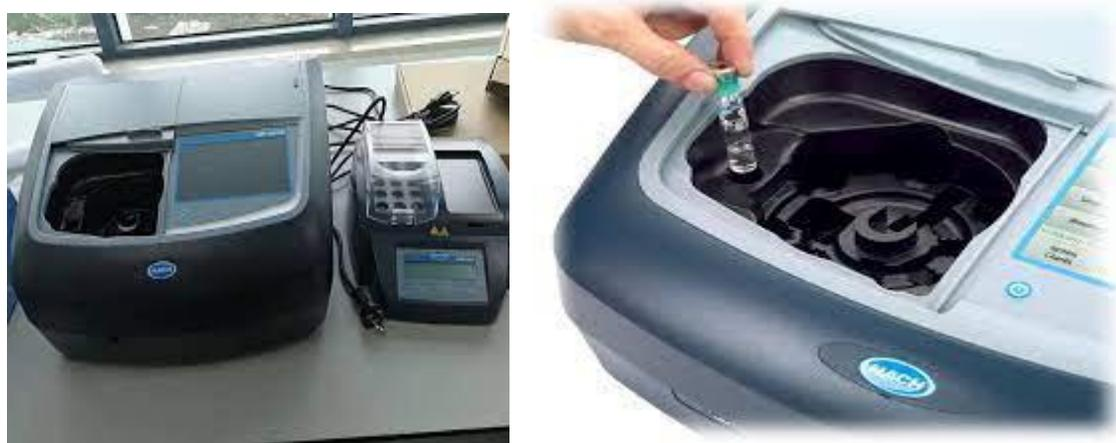
Figure II.5: Spectrophotomètre UV-VIS DR6000.
