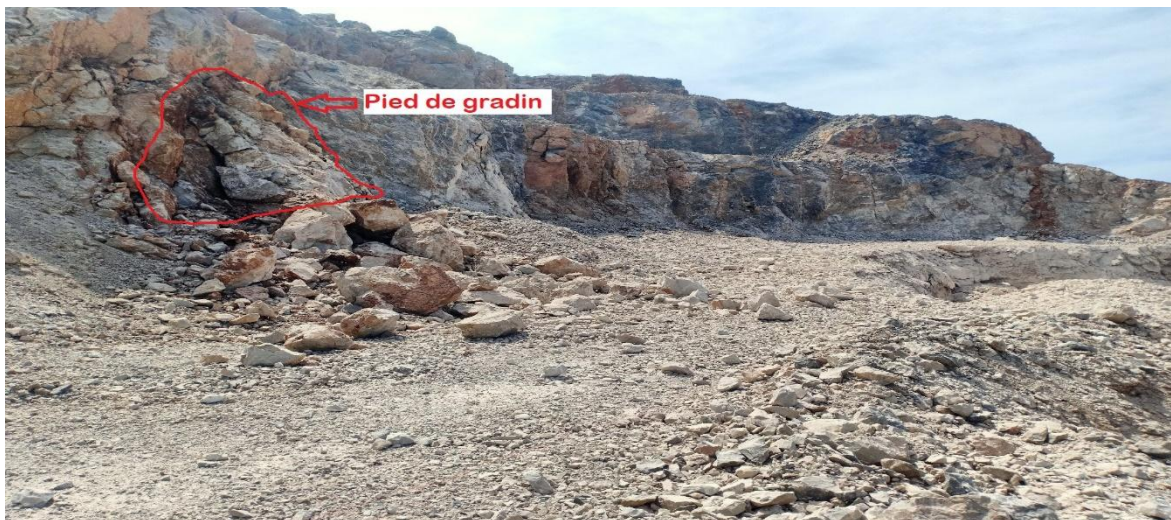
FigureIV.1 : photo du pied de gradin prise sur le terrain
