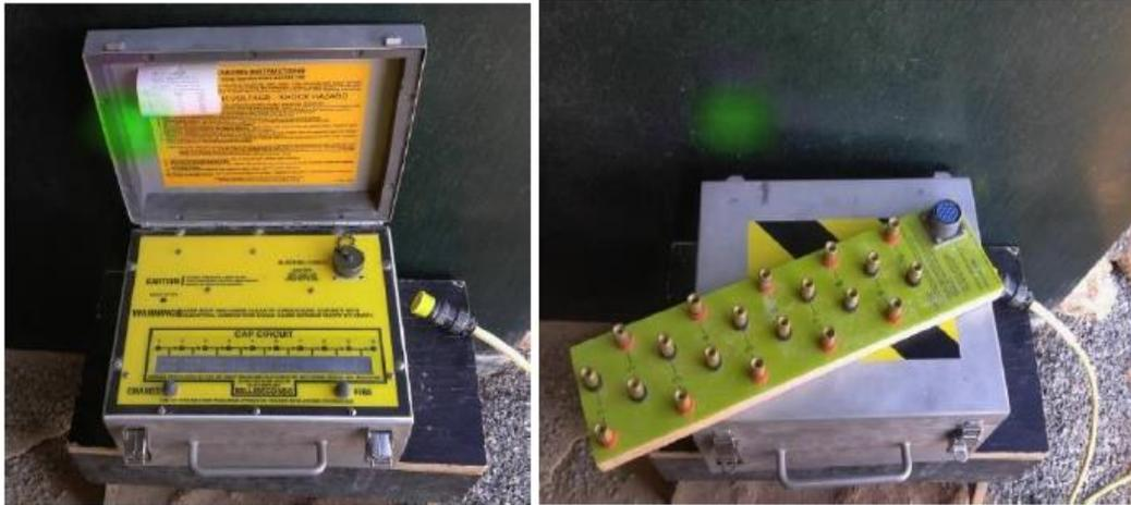
**Figure II.7.** L'exploseur utilisé pour la mise en feu.
