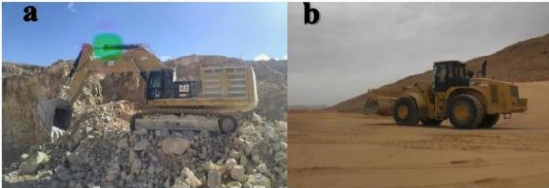
Figure II.9. Engins de chargement : (a) : pelle hydraulique CAT 390F, (b) : Chargeuse CAT 990.
