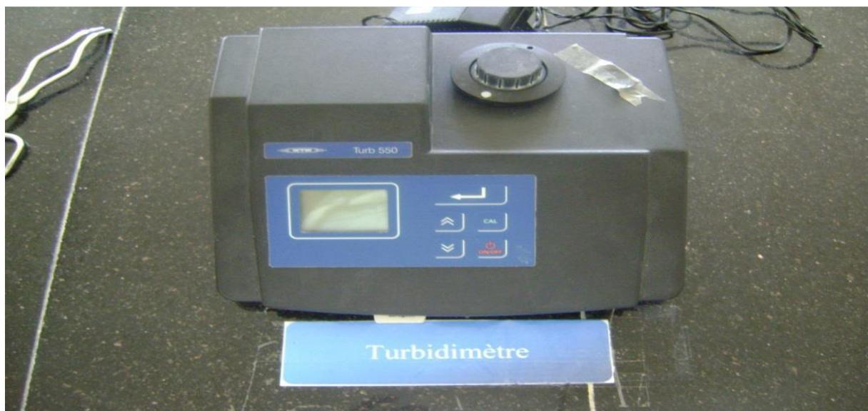
**Figure 08** : appareil de mesure de turbidité
