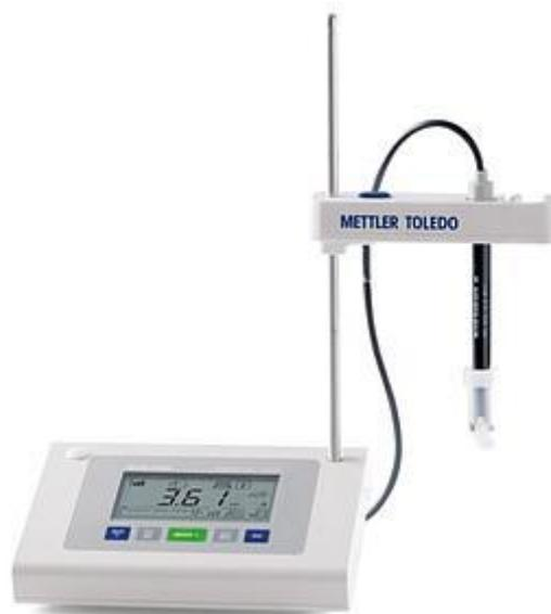
**Figure 07 :** PH-mètre de paillasse FiveEasy F20-Standard Kit - Mettler Toledo
