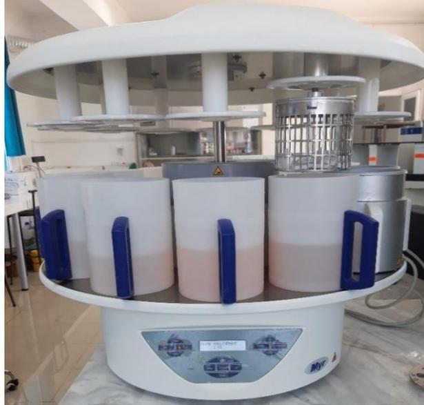
Figure n°20 : Appareil de déshydratation et d'imprégnation (Photo originale).
