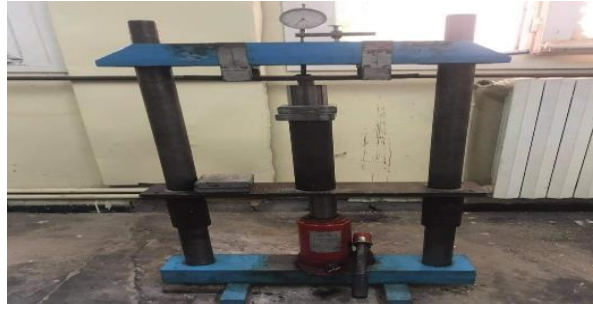
Figure III.3 : ma presse de la pastille [photo prise au niveau de laboratoire de l'université de Sétif]
