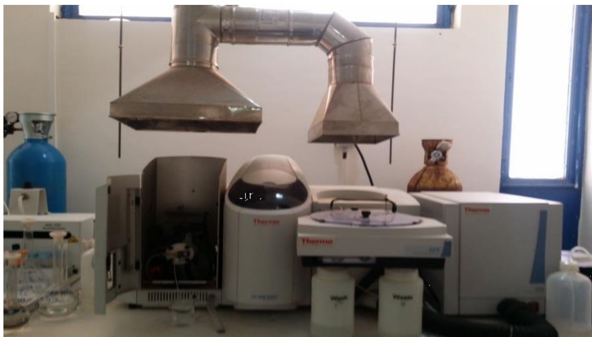
Figure III.6 : spectromètre d'absorption atomique. [Photo prise au niveau de laboratoire 11 de l'université de Bejaia]
