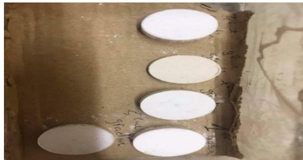
Figure III.4 : la pastille préparée avec le gypse [photo prise au niveau de laboratoire de l'université de Sétif]
