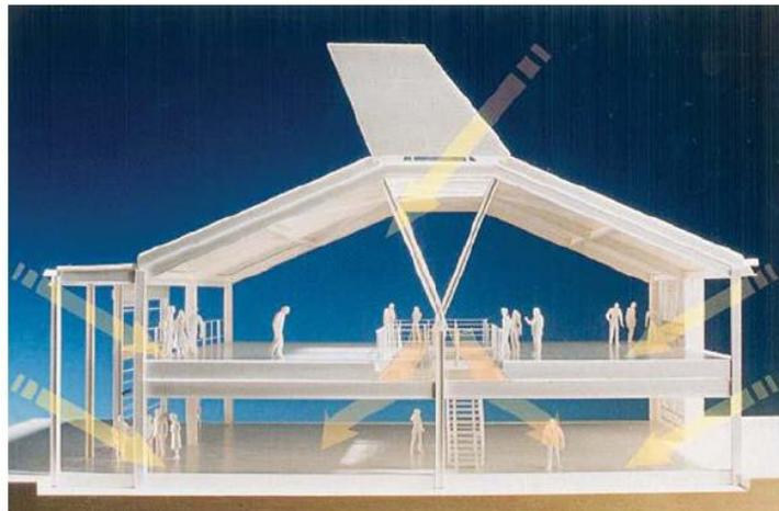
Figure1.2 : Illustration de la pénétration de la lumière du jour à travers un modèle réduit
