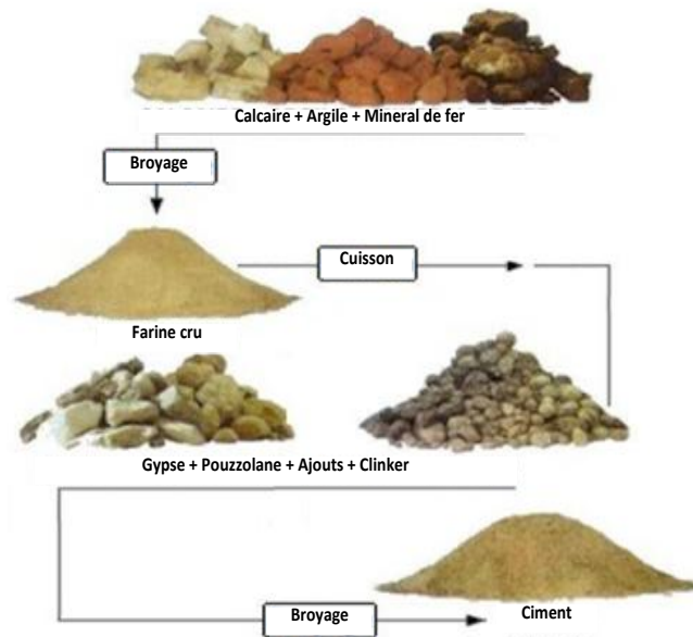
Figure II : Cycle de fabrication de ciment [4].
