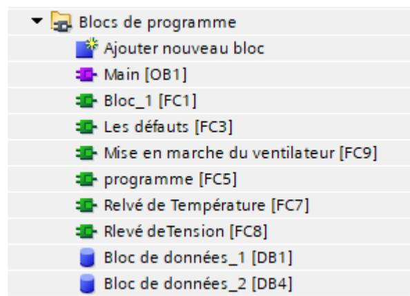
Figure III.8 : Blocs utilisés dans le projet.
