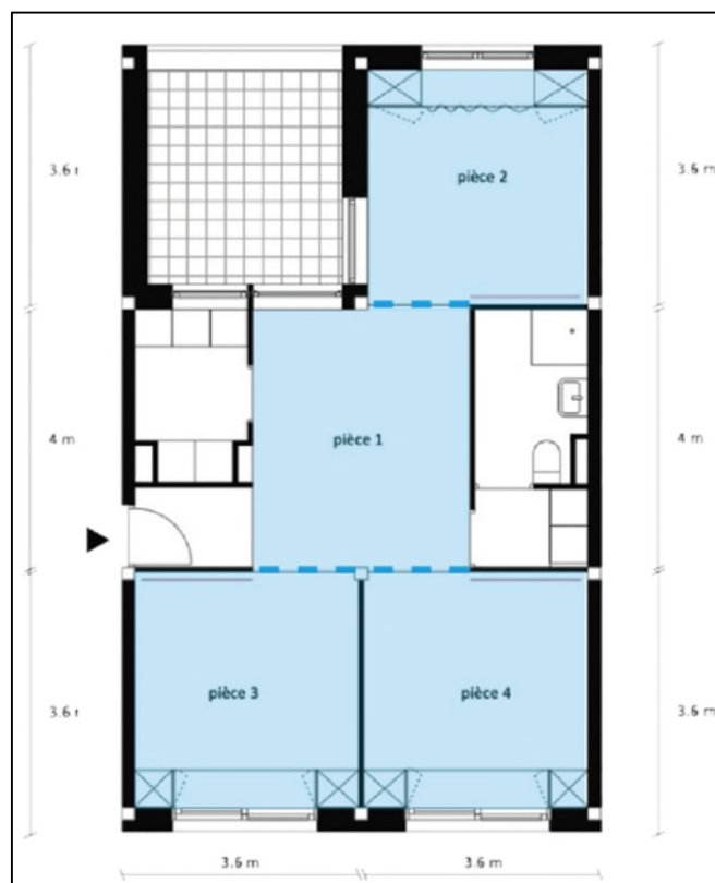
Figure 25 : plan de logement T3, Pièces carrées identiques séparés par des portes coulissantes, source : FLEURI Maya, Espaces-temps : entre hier et aujourd'hui, l'habitat évolutif pour demain, ENSA de Nantes, 2021
