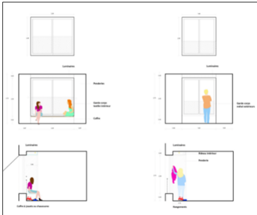
Figure 37 : Schématisation du principe de la fenêtre habitée, source : sophie-delhay-architecte.fr
