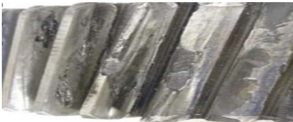
FigureI.5- Défaut de piqures.
