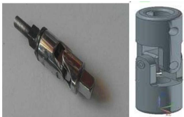
Figure II.22 Un cardan choisi pour la machine.
