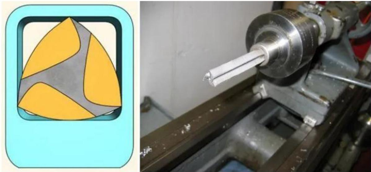
**Figure II.19** Profil réel de la partie travaillante de l'outil. [10]
