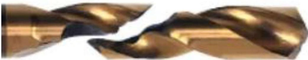
Figure I.26 Exemple de rupture du foret. [19]
