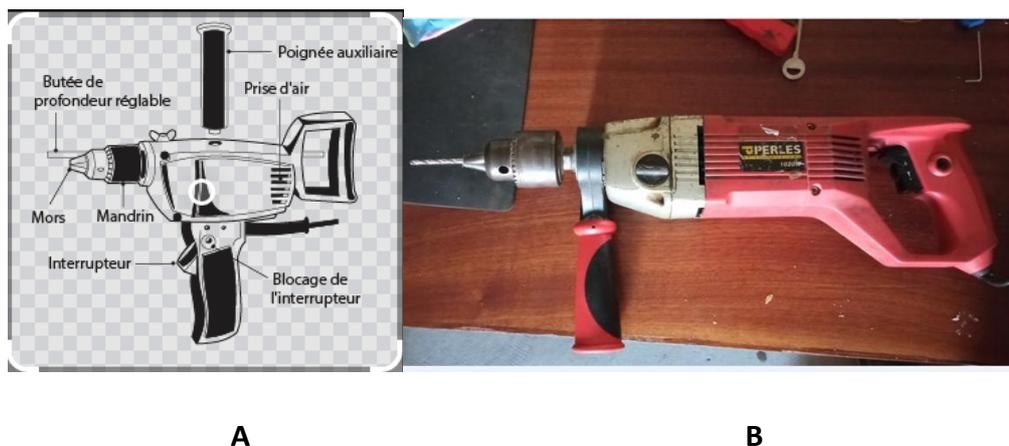
Figure III.2A) Mise en plan d'une perceuse [16], B) La perceuse de Hall de technologie
