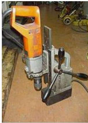
**Figure I.8** Perceuse magnétique. [2]
