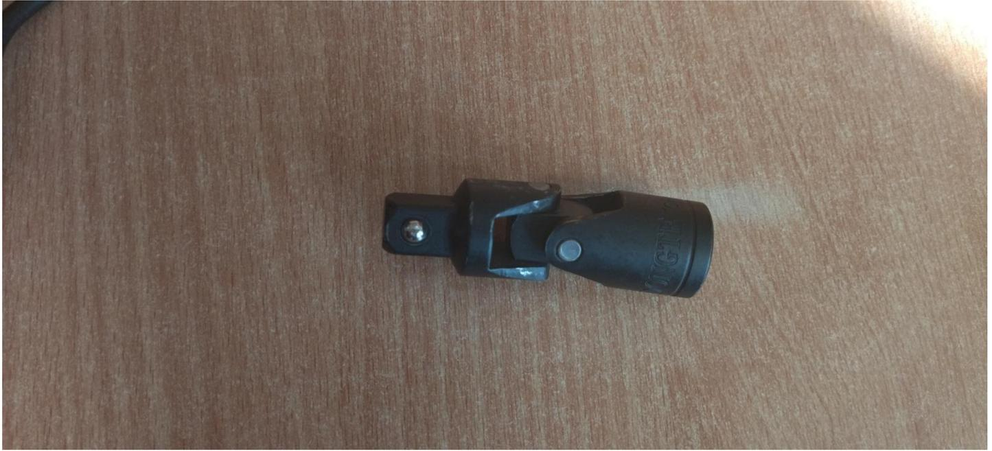
**Figure III.5** Une vue réelle du joint de cardan
