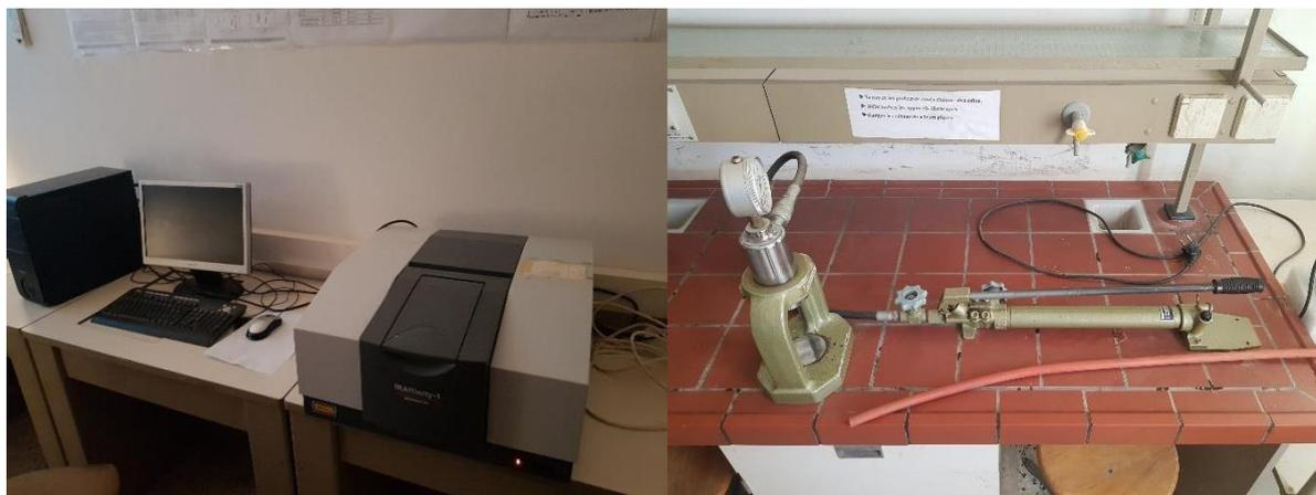
**Figure II.8.** Spectromètre de type IRAffinity-1 SCHIMADZU(a) et compresseur pour presser les pastilles (b).
