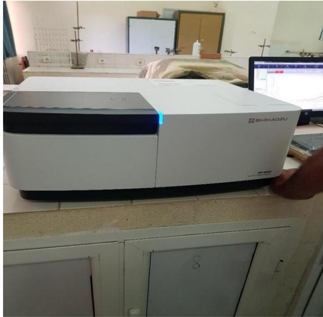
**Figure II.12.** Spectromètre de photoluminescence de type RF-6000 Shimadzu utilisé.
