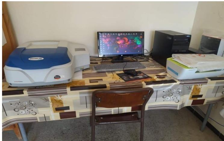
**Figure II.10.** Spectromètre UV-visible Specord 200 Plus utilisé.
