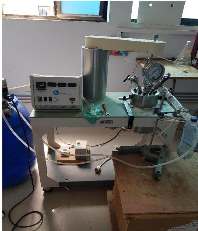
Figure II.4. Autoclave utilisé pour le séchage supercritique model Parr 4848
