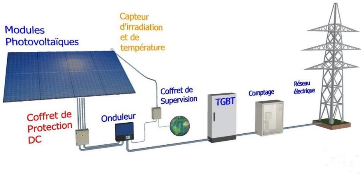
Figure I. 4 : Système raccordé au réseau.
