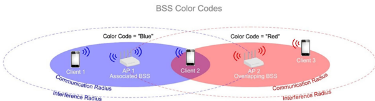
FIGURE 2.6 – Utilisation de BSS Coloring entre deux points d'accès avec 802.11ax.
