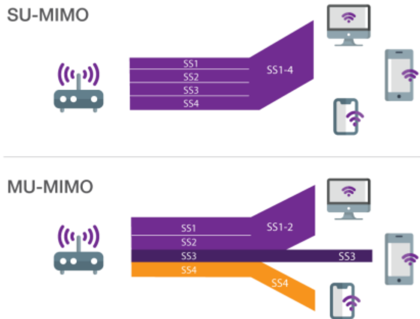
FIGURE 1.19 – Différence entre transmission SU MIMO et MU MIMO.
