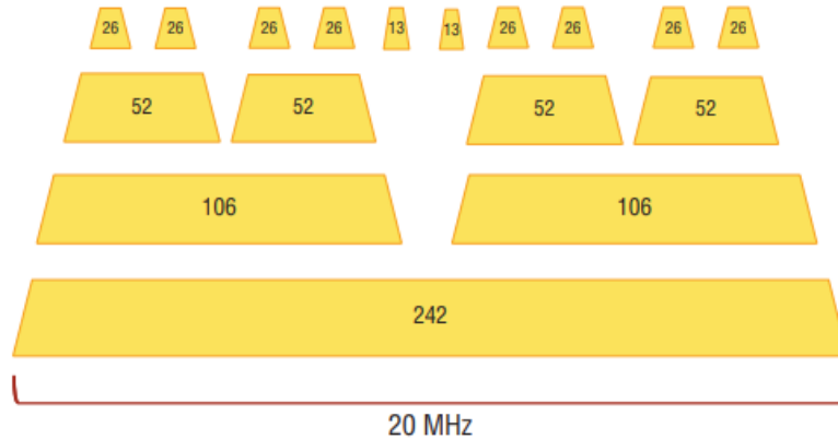
FIGURE 2.2 – Positions des RUs dans la bande passante de 20 MHz.
