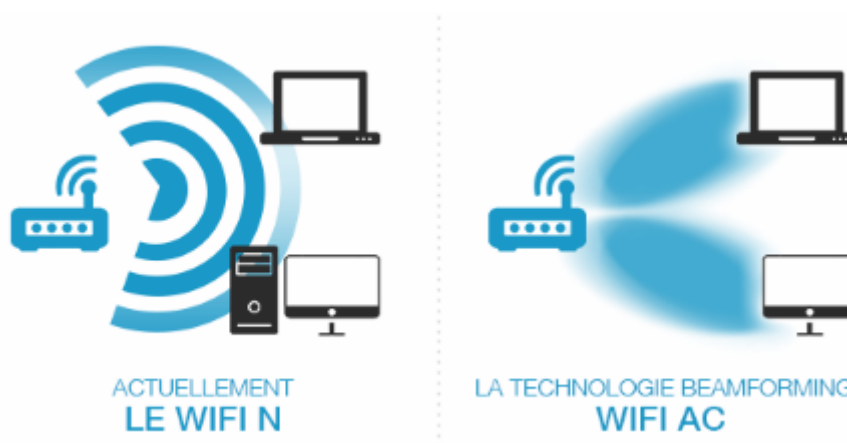
FIGURE 1.20 – fonctionnement de la technologie BeamForming.
