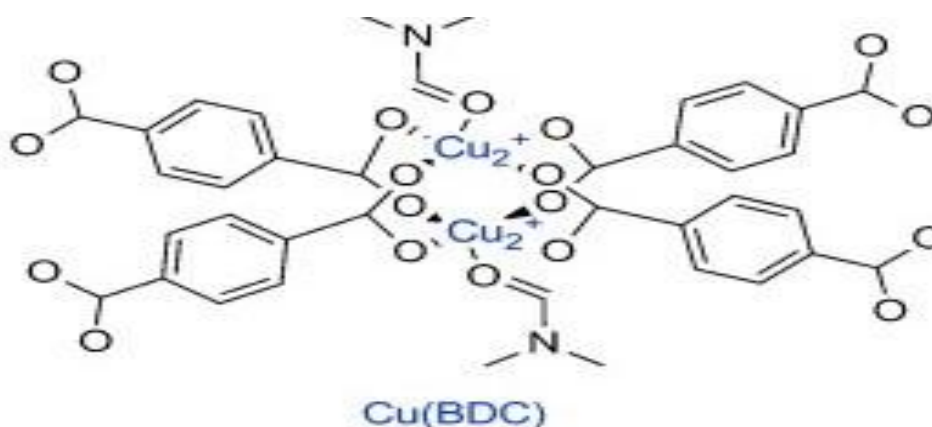
Figure II. 2 : la structure chimique de MOF Cu-BDC
