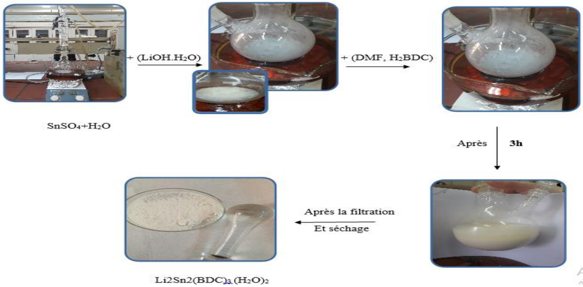
Figure II. 3: Etapes de préparation de MOF \text{Li}_2\text{Sn}_2(\text{BDC})_3 \cdot (\text{H}_2\text{O})_2
