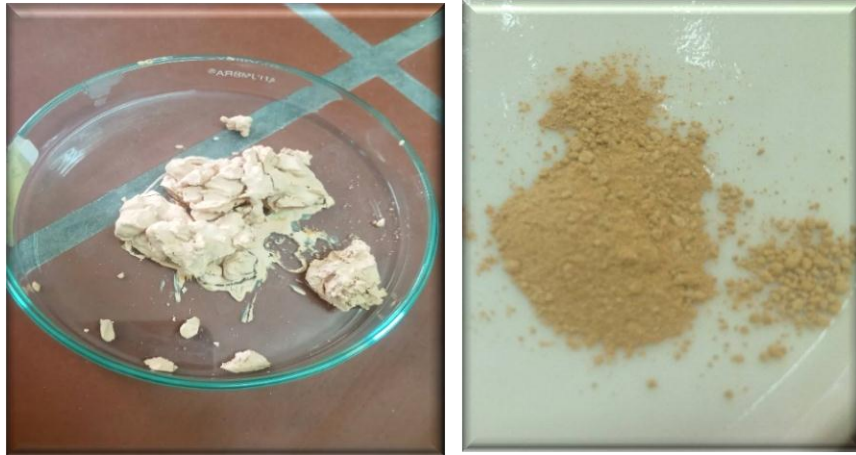
Figure II.2 : Fe-BDC avant et après broyage.
