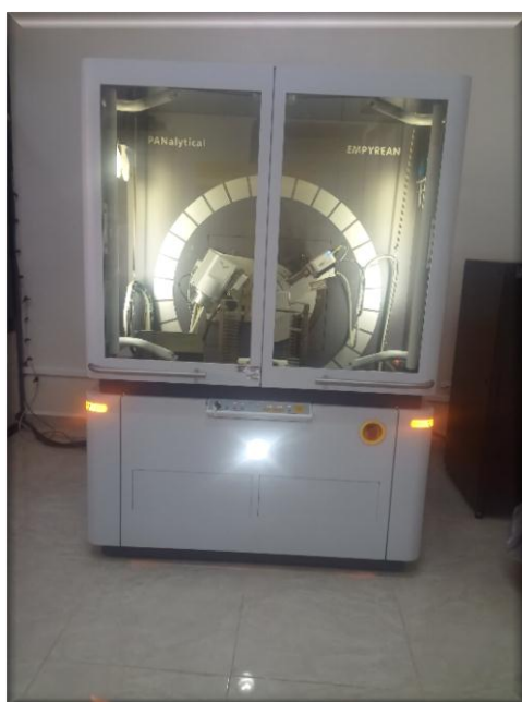
Figure .II.4 : Photos du diffractomètre à rayons X type EMPYREAN PanaLytical.
