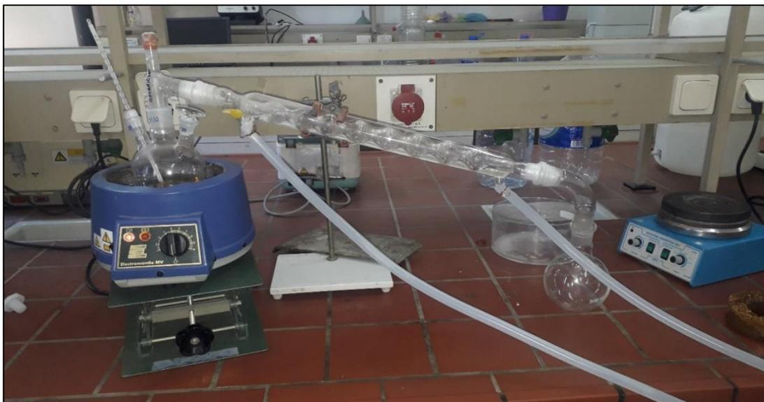
Figure IV.8 : Montage de distillation.
