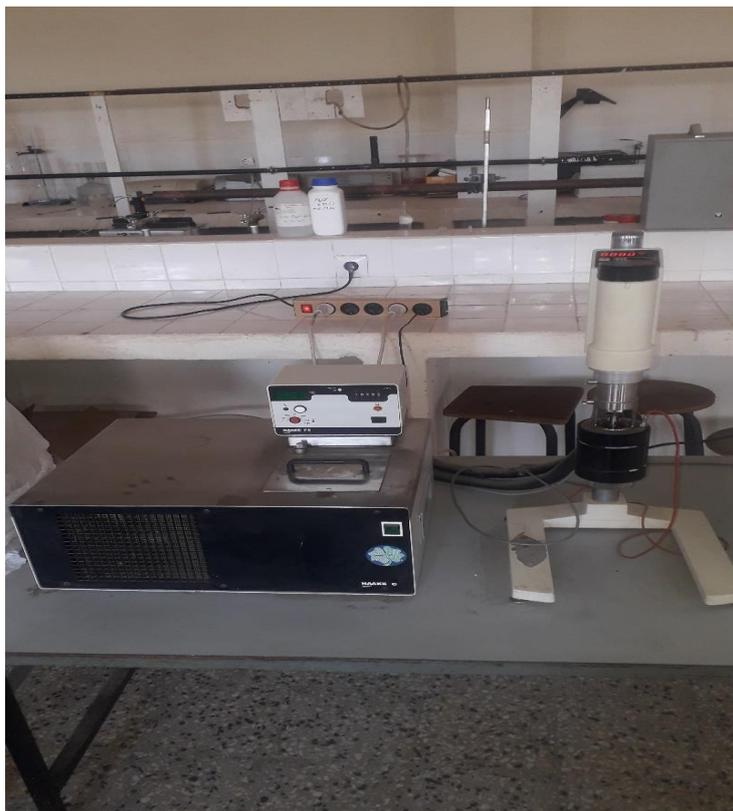
Figure IV.13 : Un viscosimètre de couette.
