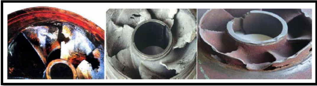
Figure (V. 6) : Cavitation d'une roue
