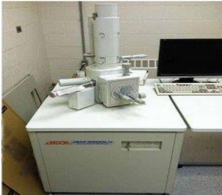
Figure II. 4: Microscope électronique à balayage JEOL 5600LV.
