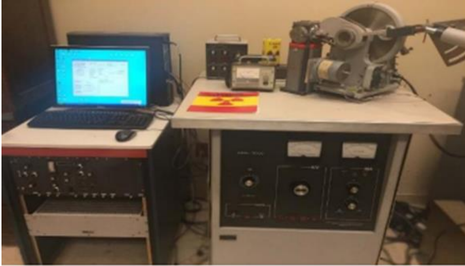
Figure II. 2: Diffractomètres de type XRG 3000.
