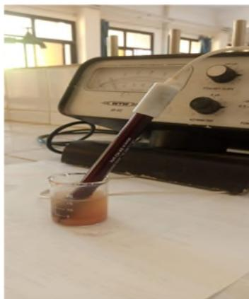
**Figure 15:** détermination du pH.
