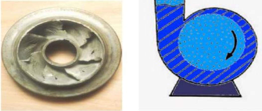
Figure (5.3) : Principe de la cavitation
