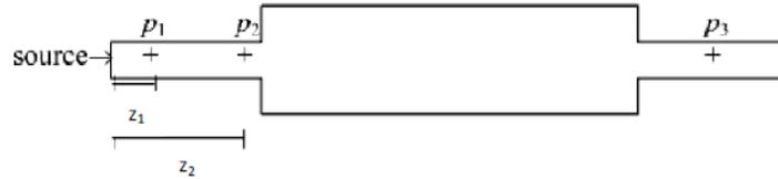
FIGURE 2.3 - Les points de mesure pour la méthode des trois points (Abom M. 1991)
