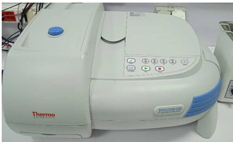
Figure II.8 : SpectrophotomètreUV-Visible de marque thermo scientifique
