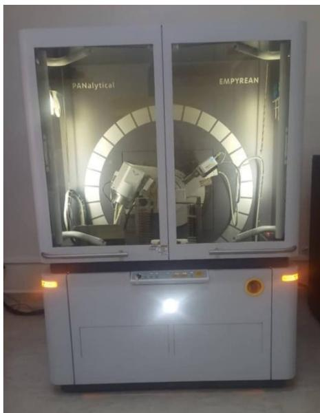
**Figure II.2** : diffractomètre de type panalytical EMPYREAN.
