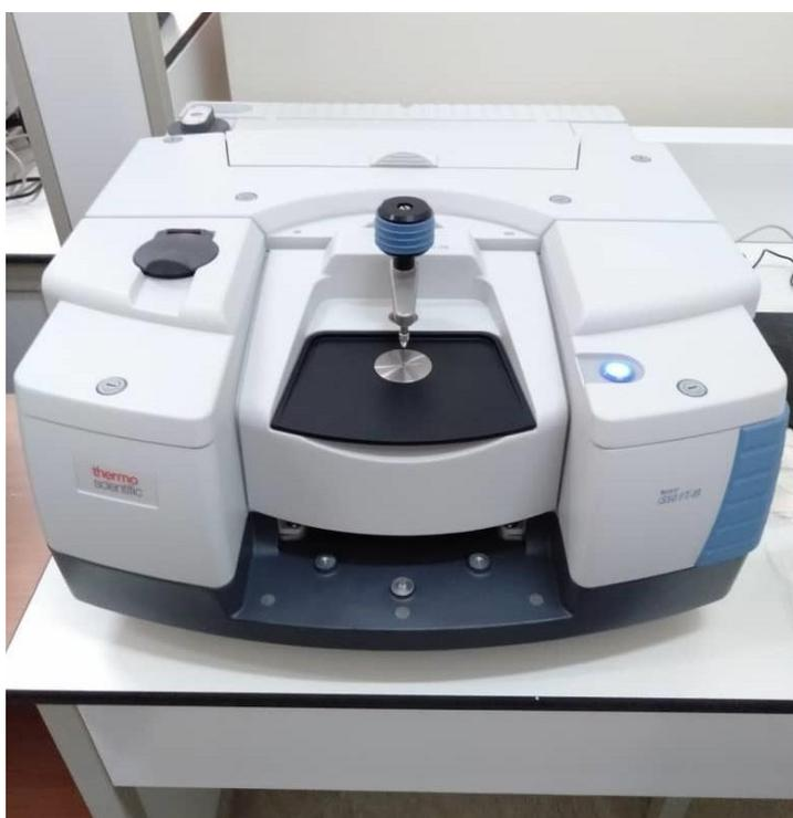
**Figure II.3 :** Appareil d'analyse par rayonnement infrarouge
