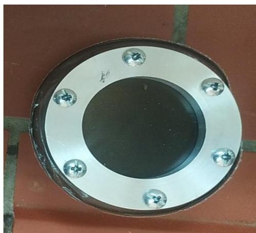
**Figure II.2** : coupelle utilisée pour la mesure de la PVE
