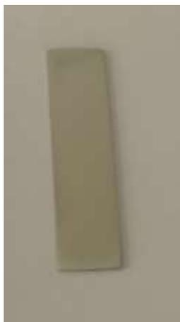
**Figure II.5 :** Electrode de travail en acier.
