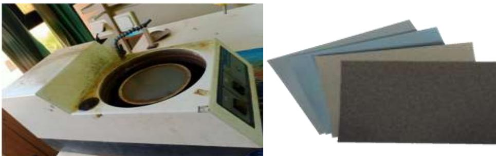
**Figure II.1:** Une polisseuse et papier abrasif
