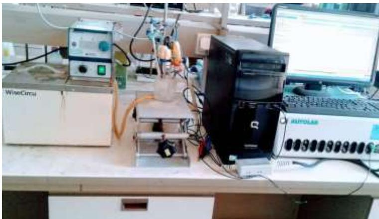
**Figure II.3** : Dispositif expérimental **AUTOLAB** de mesure de l'impédance électrochimique.
