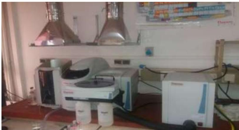
**Figure II.17 :** Spectrophotomètre d'absorption atomique Thermo Scientific de type ICE 3500.
