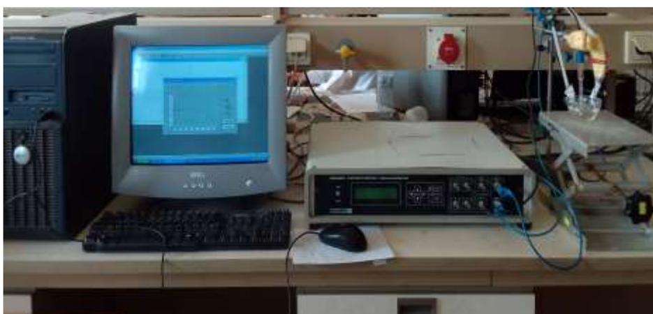
**Figure II.2 :** Dispositif expérimental de mesure potentiodynamique, potentiostatique et galvanostatique.
