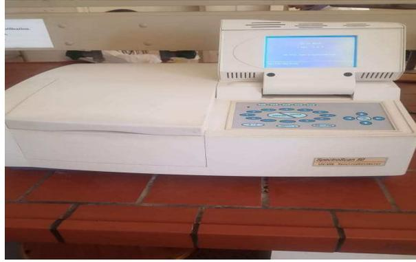
**Figure V.3.** Présentation d'un spectrophotomètre UV-visible
