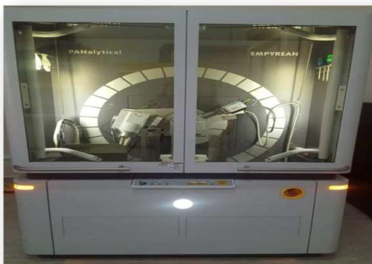
**Figure V.6.** Présentation d'un diffractomètre de Rayon X
