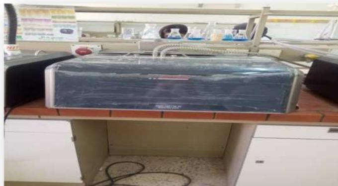
**Figure V.4.** Représentation d'un granulomètre laser
