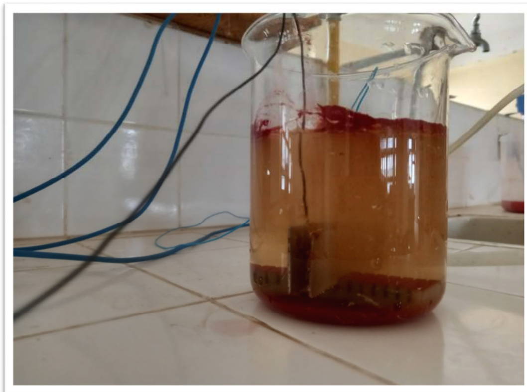
Figure II.2. Cellule électrochimique de forme cylindrique.
