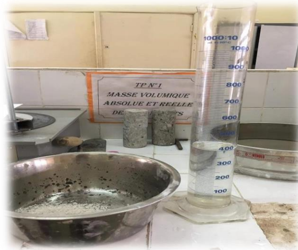
Figure III.14: Matériels utilisés pour le calcul de la masse volumique absolue du sable.
