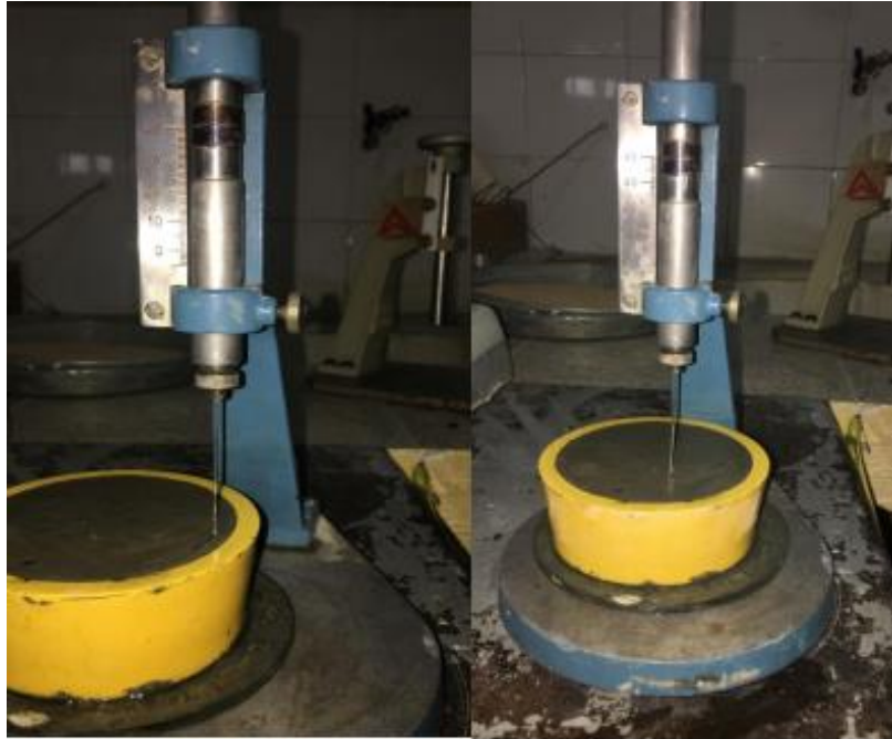
Figure III.5 : Fin de prise sur les différentes positions.
