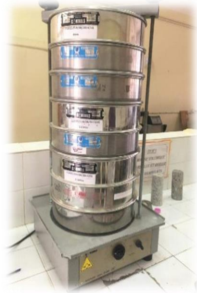
Figure III.18: Opération de tamisage.
