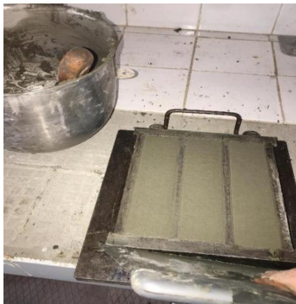
Figure IV.4: Remplissage des moules.
