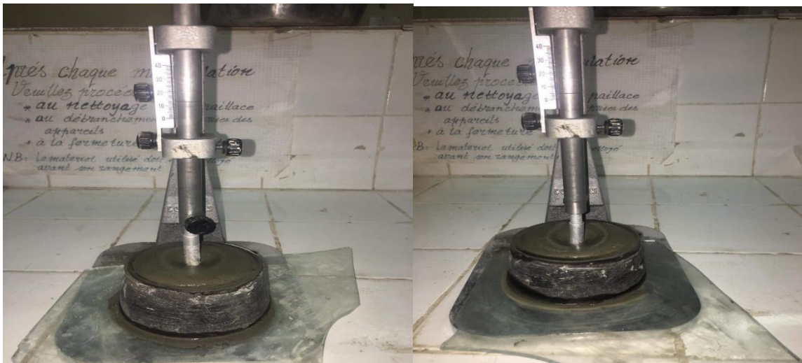
Figure III.2 : Essai de consistance sur l'appareil de Vicat avec de différents pourcentages d'eau.
