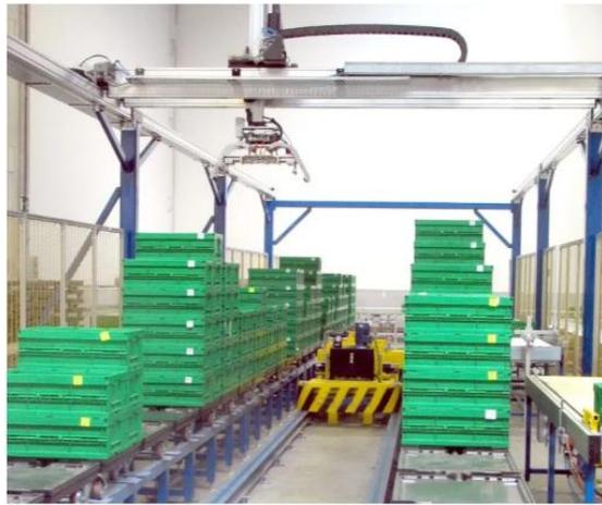
*Figure II.5 : Robot cartésien portique tecno-840.*
