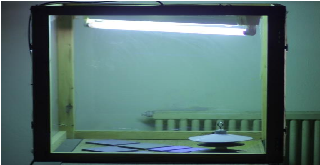
Figure III. 5: Cellule de test pour le vieillissement UV des modèles des isolateurs en silicone dans les conditions de test avec seul lumière de la lampe à UV
