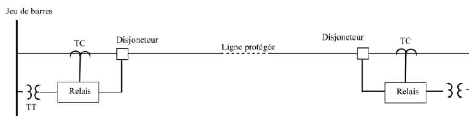
Fig.II.9 : Structure d'un système de protection
