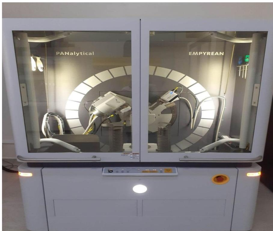
**Figure II.2** : Diffractomètre (DRX).
