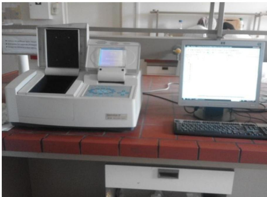
**Figure II.1** : spectrophotométrie UV-visible.
