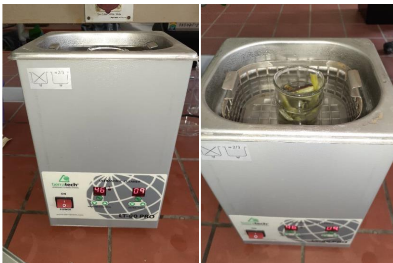
Figure 22: isolation des fibres d'orties par ultrason.
