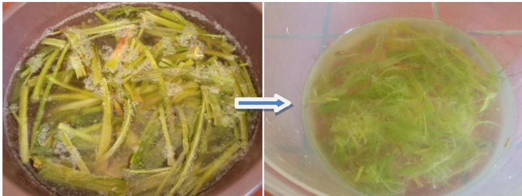
Figure 21: photos montrant les fibres avant et après l'extraction.
