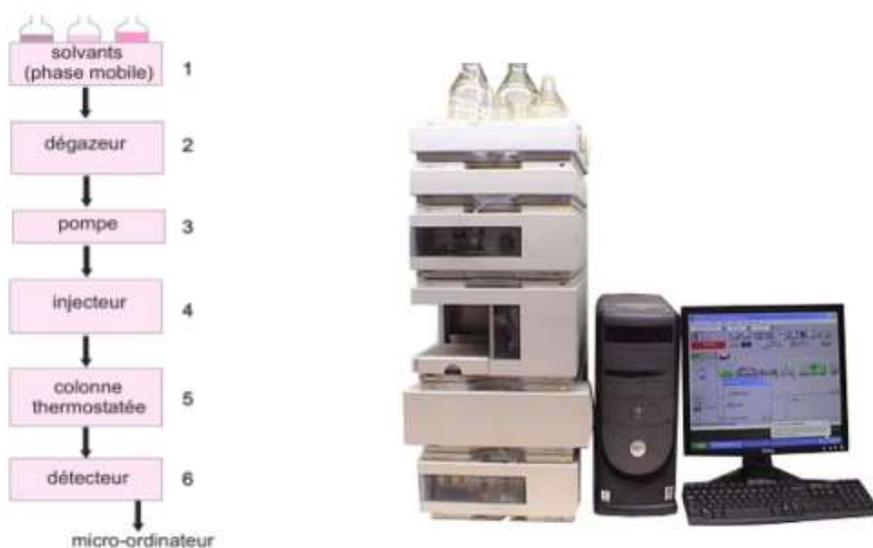
Figure III.1 : Installation en HPLC [112]
