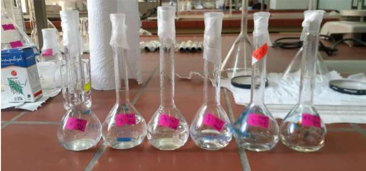
**Figure IV.5 : Solutions étalons filles préparées.**
