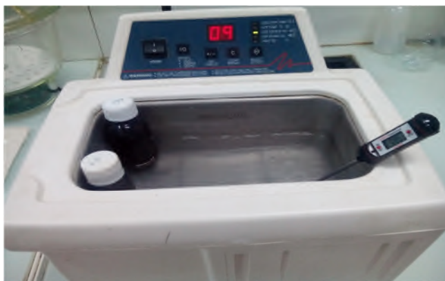
Figure 5 : Bain à ultrasons utilisé pour l'extraction des composés phénoliques
