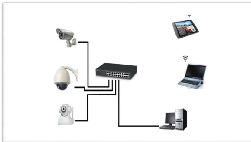
Figure i - équipement de réseaux vidéo surveillance [20].
