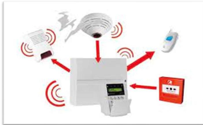
Figure ii - Réseaux de système d'alarme [20].
