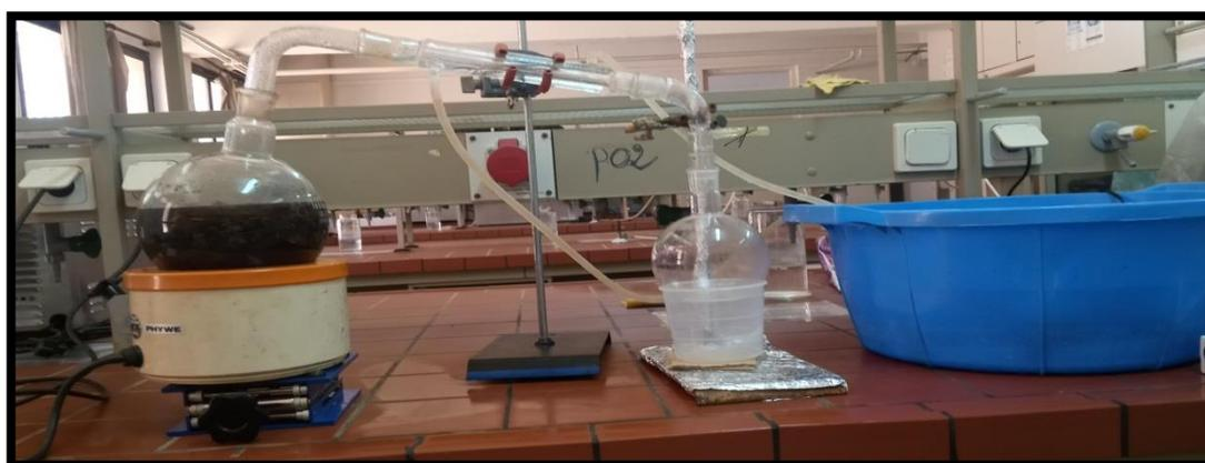
Figure 15: Montage utilisé pour l'extraction des huiles essentielles.
