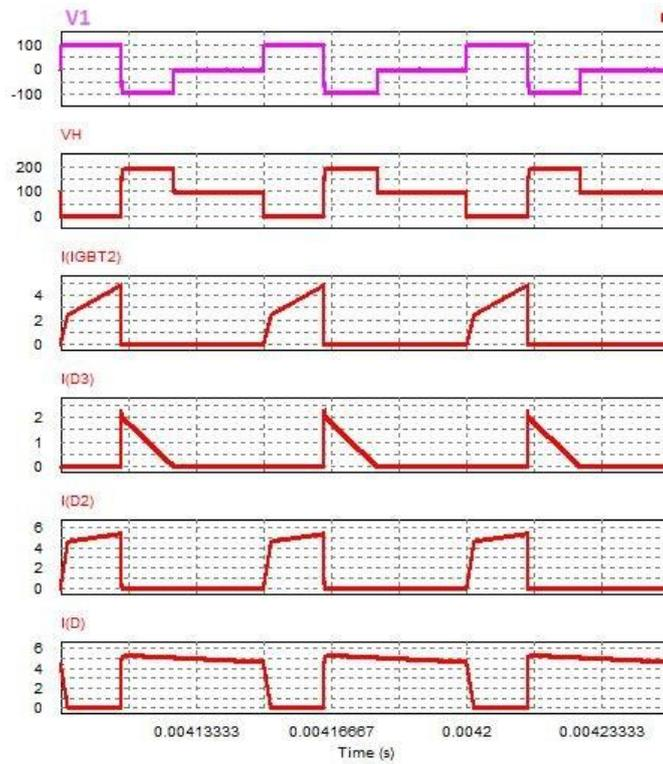
**Fig.I.9-** Allures des grandeurs électriques principales pour le mode de conduction discontinu (DCM) d'un montage FORWARD.
