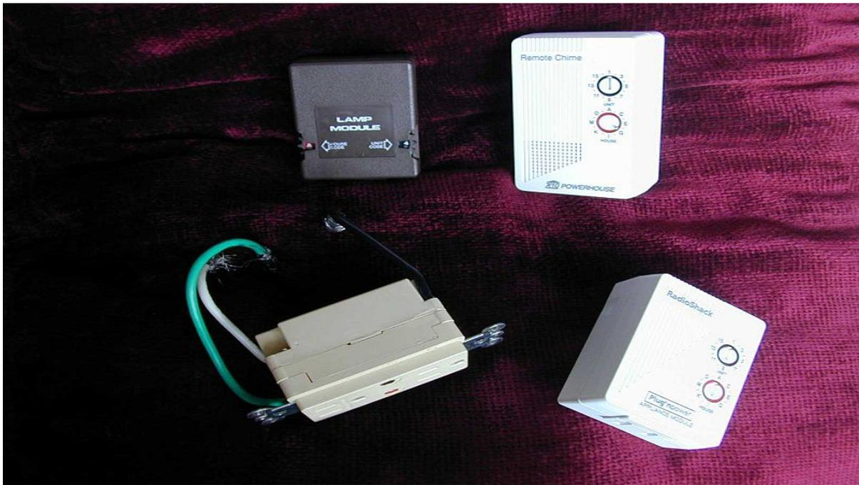
FIGURE 1.15 – Exemple de modules X-10
