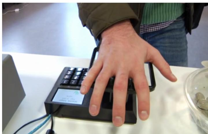
FIGURE 1.8 – Exemple de dispositif pour la détection biométrique veineuse [13].
