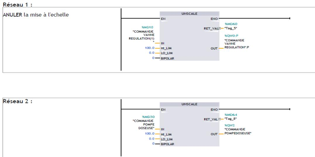
**Figure III.25 :** Commande vanne régulatrice et commande de la pompe doseuse.
