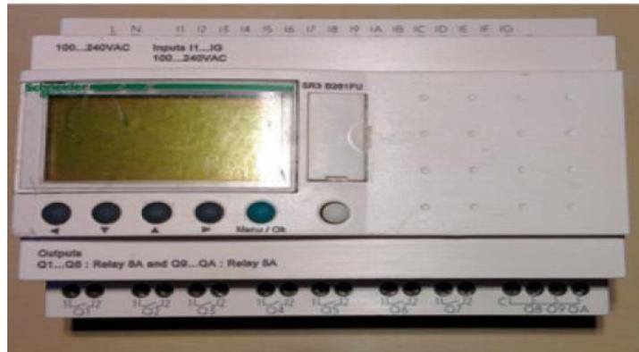
Figure II.5 : Automate programmable de type compact
