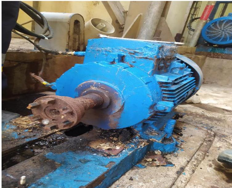
**Figure I.7:** Un moteur asynchrone.
