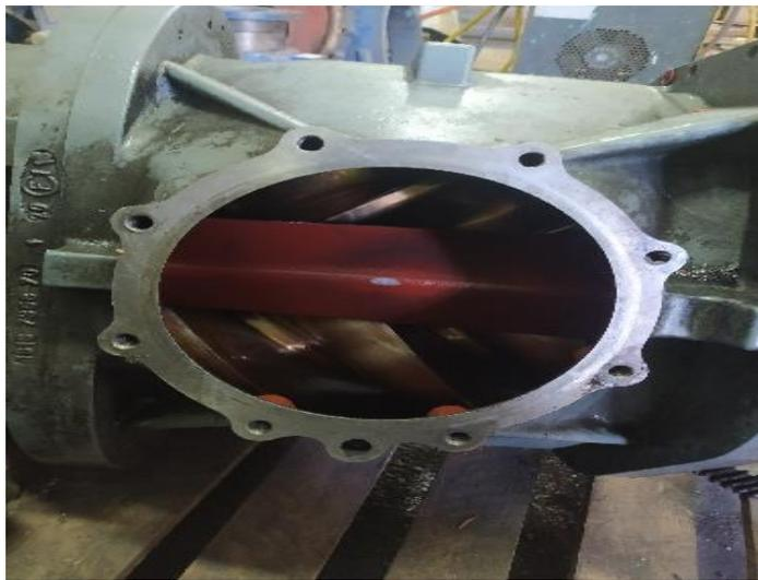
**Figure I.10:** Un compresseur à vis.
