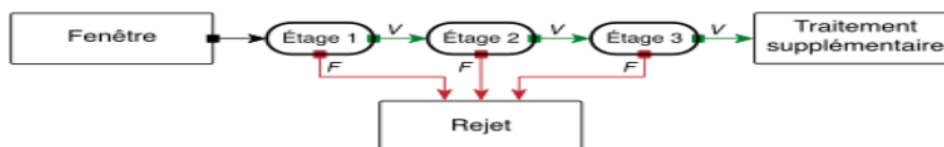
FIGURE 3.6 – Illustration de l’architecture de la cascade : les fenêtres sont traitées séquentiellement par les classifieurs, et rejetées immédiatement si la réponse est négative (F).
