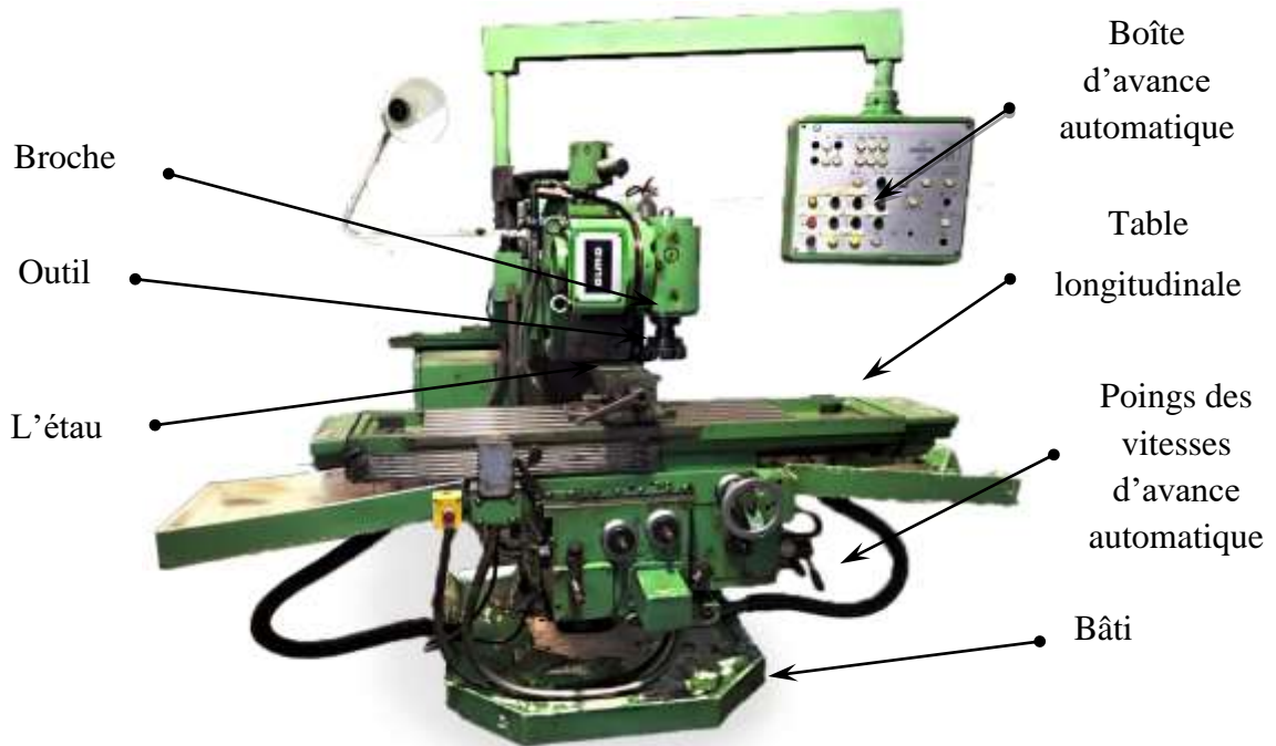
Figure III.3: fraiseuse conventionnelle FH 1.6 utilisé disponible au niveau du hall de technologie du département génie mécanique
