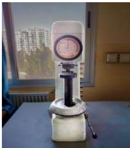
Figure III.8 : Machine de dureté universelle Brinell, Vickers et Rockwell
