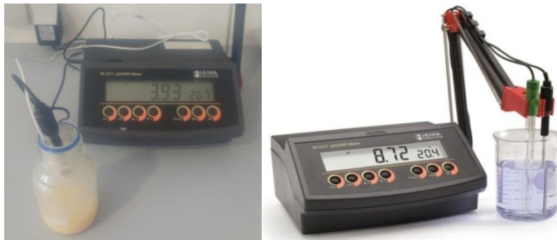
Figure 5 : pH-mètre de paillasse utilisé lors de la manipulation, marque HANNA, modèle HI-2211.
