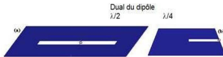
**Figure I.8 :** Les antennes à fente (a) demi-onde, (b) quart d'onde
